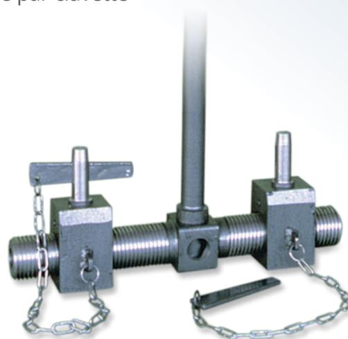
**ATR6 MC** | Appareil à tirer les rails non percés (ou à tirer les barres longues)
